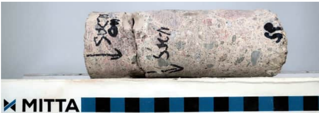
Kuva 10. Näyte SOK 10, 1968 TEKN. Ulkopinta vasemmalla.
