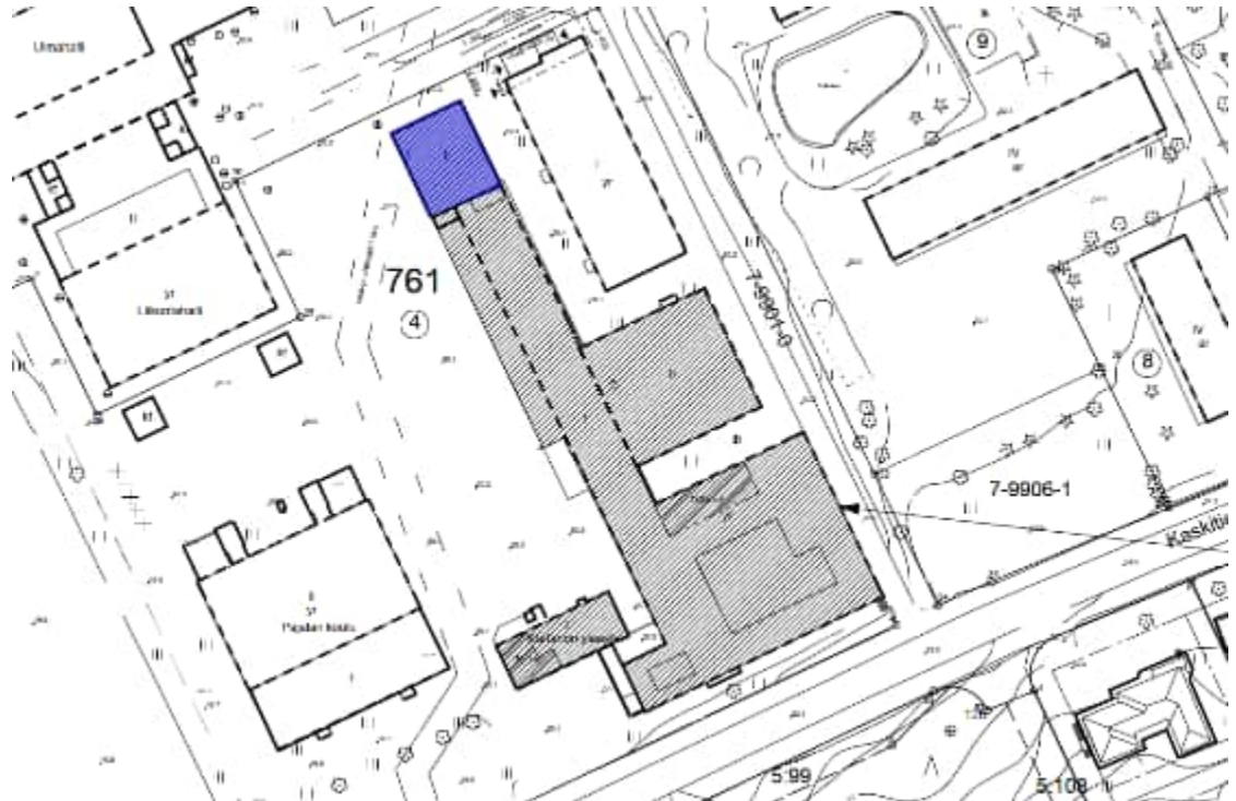
Kuva 5.90. Vuoden 1988 laajennososan paikannuspiirustus korostettu asemapiirustukseen sinisellä
