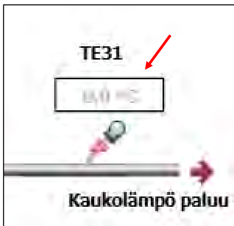
Kuva 57. Lämmönjako 2 KL-paluuveden lämpötila-anturi TE31 arvo on nolla, anturi on rikki tai sellaista ei ole.
