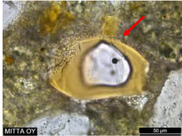
Kuva 3. Portlandsementtiklinkeriä ja masuunikuonaa (punainen nuoli) sideaineessa. PPL
