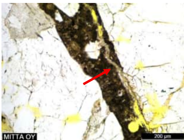
Kuva 9. Silikageeliä (nuoli) halkeamassa. PPL PPL = plane polarized light, UVL = ultraviolet light
